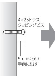
② フレームを①のビスに引っ掛け、ビスを最後まで締めます。
