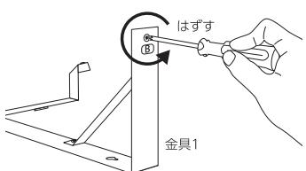
④ 金具2のBの穴の上に、金具3のBの穴を合わせ、③ではずしたビスでしっかりと締めます。
