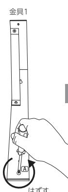
② 金具1のAの穴の上に、金具2のAの穴を合わせ、①ではずしたビスでしっかりと締めます。
