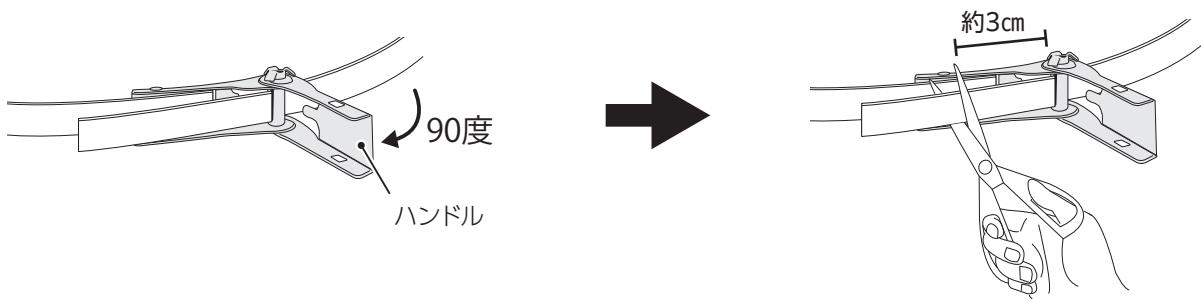
**5 ハンドルを小刻みに左右に動かしてステンベルトが十分に締まつたら、ハンドルを倒して、ストレーナーを閉じます。**
