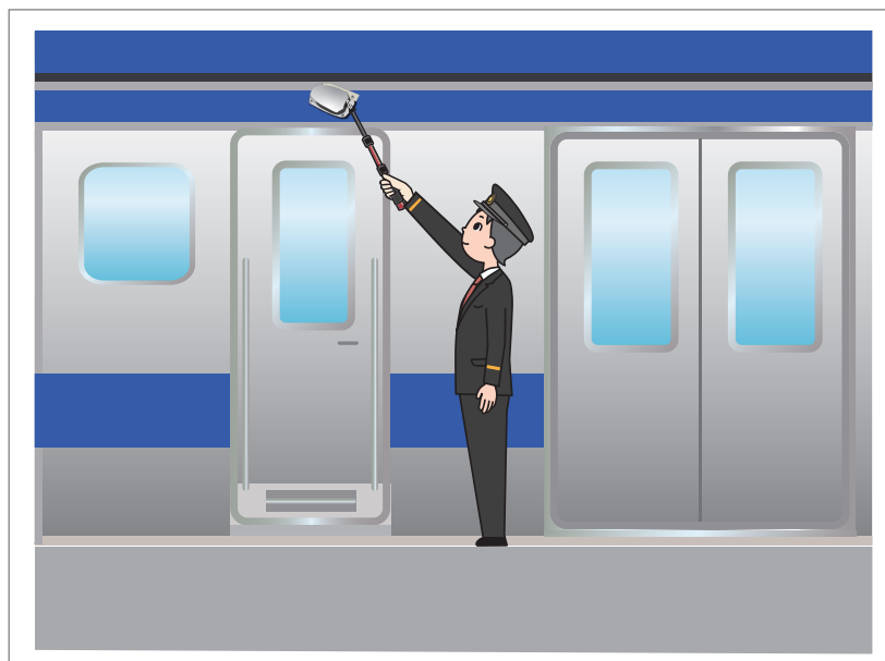
車両の外側に設置されたカメラのレンズ部を清掃する
