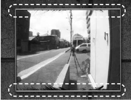
経年劣化の例：耐候性不良により発生した黒ジミ。劣化が進み見えにくくなってきたミラーでも、無料で「補修用ミラー」を提供している
