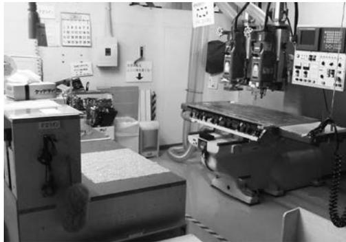
切削加工機（右側）と接着作業台（左側）が向かい合わせに配置しており、振り向くだけで両方の作業ができるようになっている
