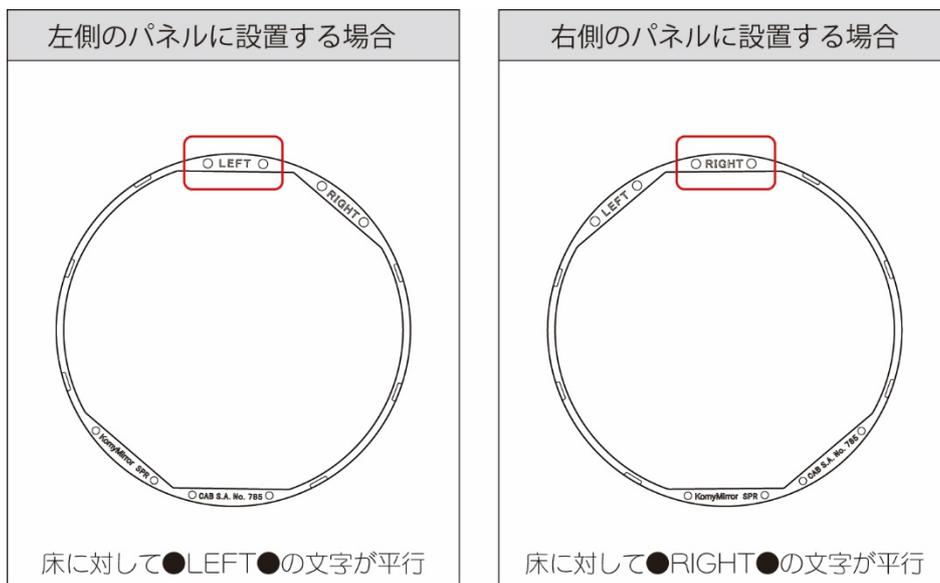
設置角度を変えることでサイドパネルの左右どちらでも設置可能
